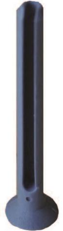
Die optimale Spreizwirkung erreicht man bei Verwendung maßhaltiger Bohrer von 6 bzw. 8 mm Durchmesser. Die Spreizwirkung entlang der Längsachse gewährleistet immer festen Halt auch in schwierigen Untergründen wie Hochlochziegel (ohne Schlag bohren) oder Gasbeton, wo herkömmliche Spreizdübel ihre Schwierigkeiten haben.
