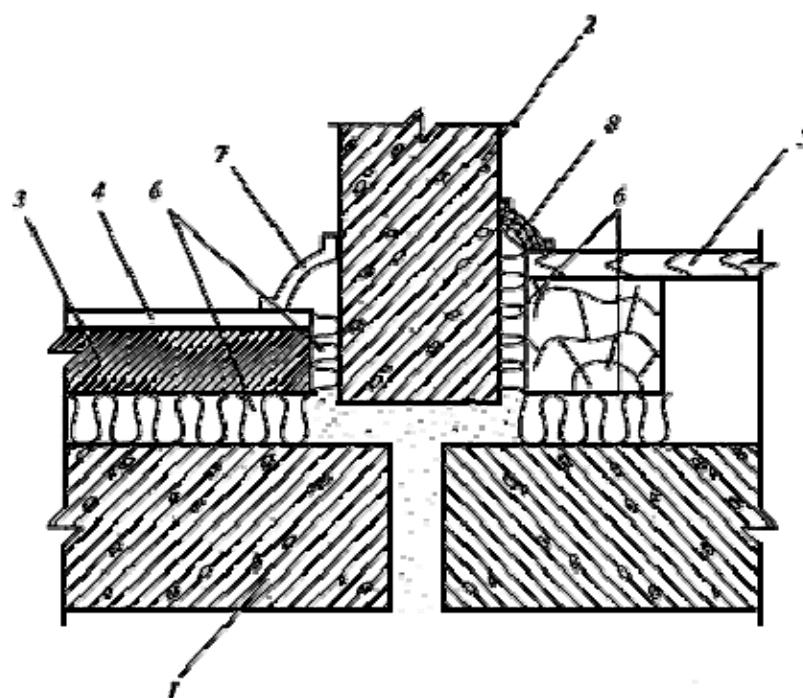
1 - несущая часть междуэтажного перекрытия; 2 - стена; 3 - бетонное основание пола;
