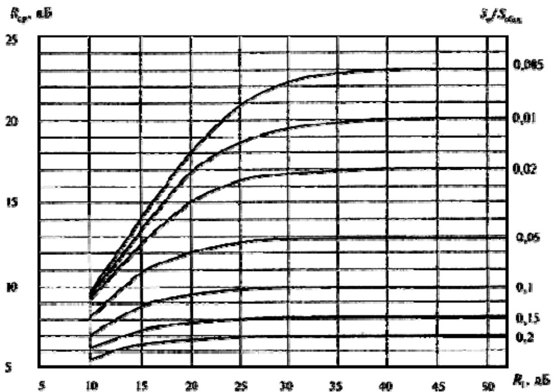
Рисунок 14 - Звукоизоляция ограждающей конструкции с открытым проемом (отверстием)
