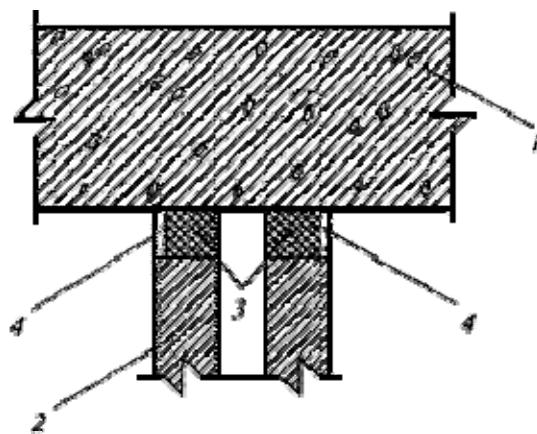
1 - несущая часть перекрытия; 2 - элемент перегородки; 3 - герметик (уплотняющая прокладка или шнур);
