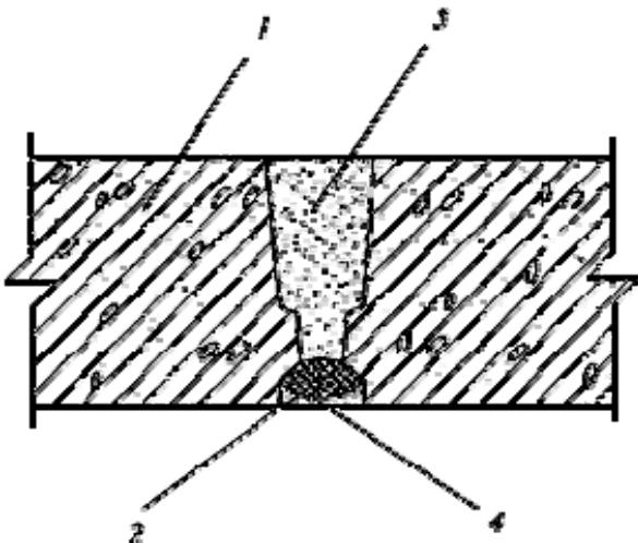
1 - сборный элемент перекрытия; 2 - герметик; 3 - монтажный бетон; 4 - раствор
