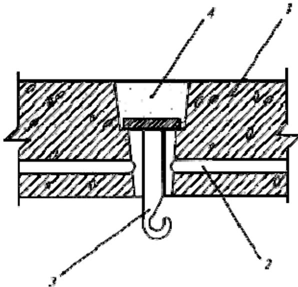
1 - панель перекрытия; 2 - электроканал; 3 - крюк, приваренный к круглой стальной пластине;
